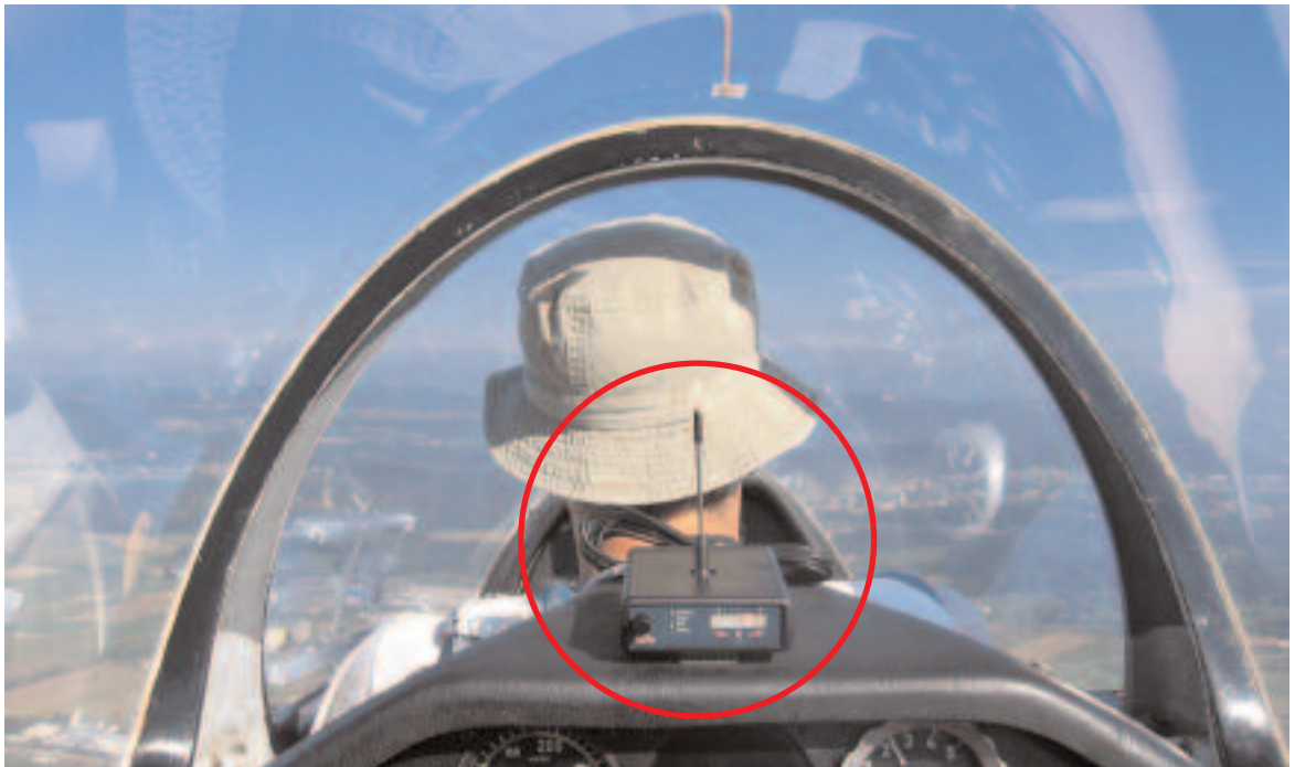
Intensivleuchtende LED zeigen gefährlichen Verkehr an. Richtung und Gefährdung werden dargestellt. Gleichzeitig ertönt ein Signal.
